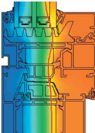
Isothermenverlauf AWS 75.SI Isotherm flow AWS 75.SI
